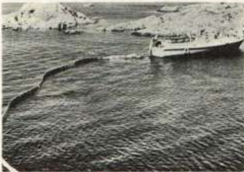
Foto 1: Op deze foto ziet men hoe een boot van de Zweedse douane (die belast is met de bestrijding van waterverontreiniging) bezig is het scherm uit te zetten, om een baai af te sluiten. Een man achter op de boot zet het scherm uit.
