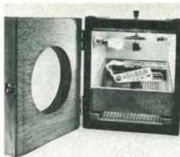
Broedmachine van het merk Succes; kan ongeveer 45 eieren van de Californische kuikwartel herbergen.
